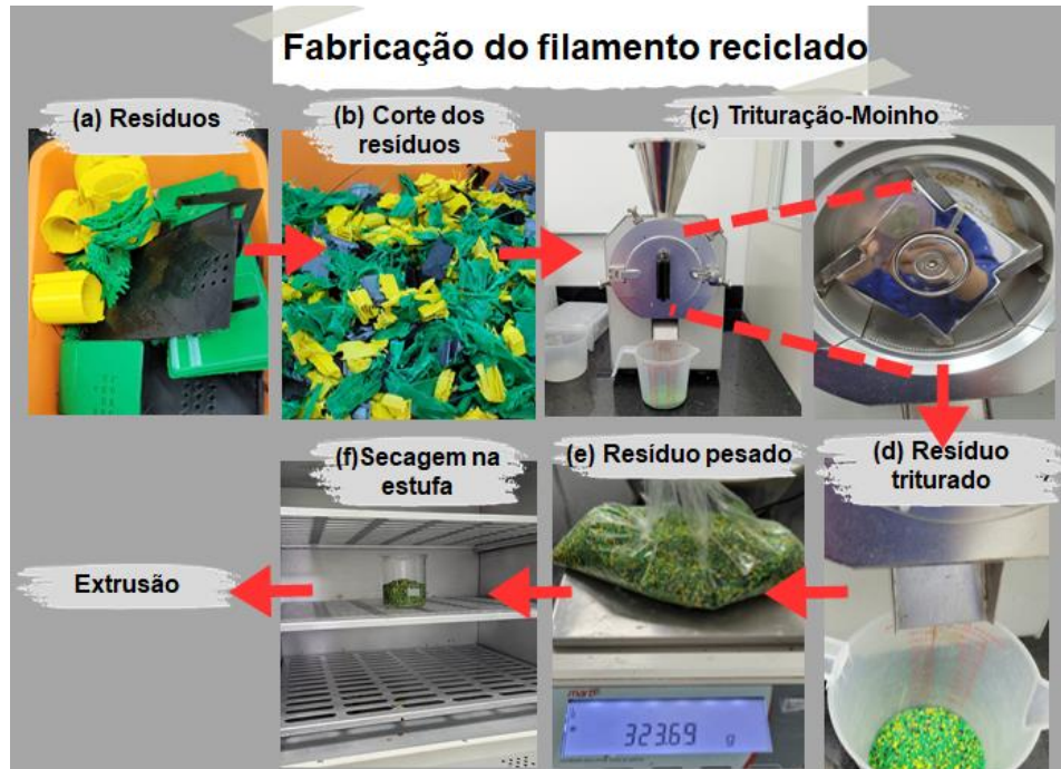
Figura 3 – Proceso de fabricación de filamentos reciclados a) Residuos. b) Corte de residuos. c) Molienda en el molino. d) Residuos triturados. e) Pesaje de los residuos. f) Secado en el horno
