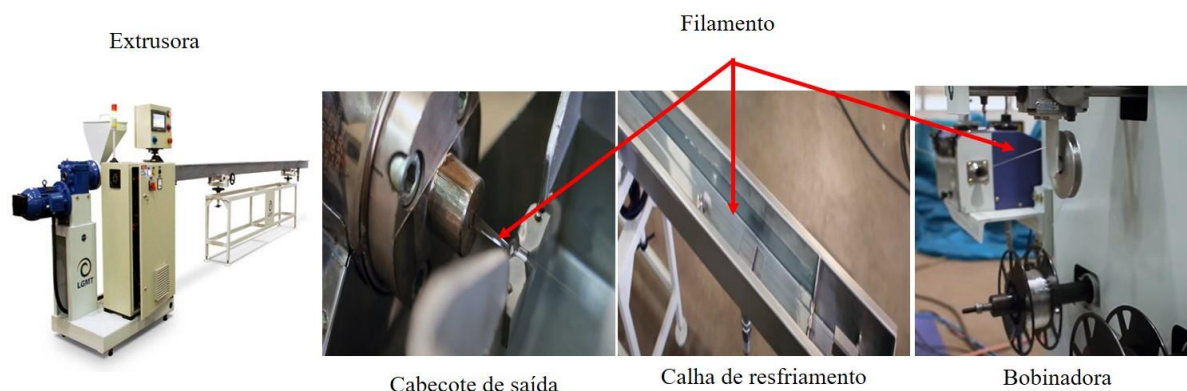
Figura 2 – Proceso de extrusión industrial de filamentos PLA
